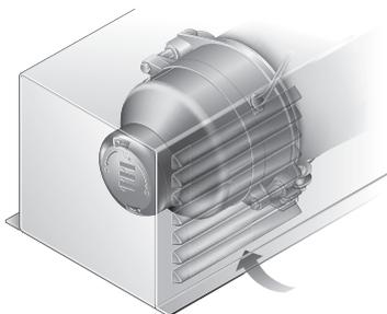
Засасывание воздуха для сгорания через гибкий шланг  $\varnothing$  60 мм, длина макс. 1 м.
